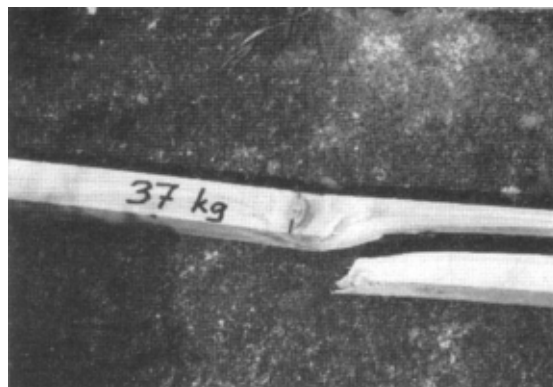
Test d'un sciage défectueux: la résistance atteint seulement 25 % de la charge de rupture spécifique obtenue à partir de 6 essais menés sur des membrures saines.
